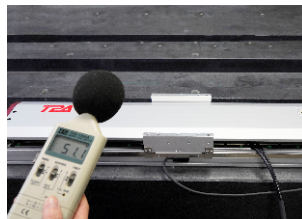
9. 模组运行噪音检测。 Running noise detection of module.
